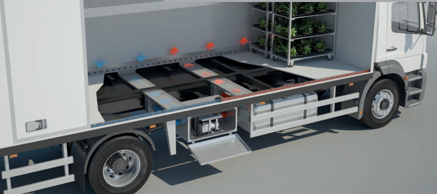
Een waterverwarmingssysteem is ideaal geschikt als laadruimteverwarming. Zeker wanneer u temperatuurgevoelige producten vervoert. Een waterverwarming in combinatie met een blower unit voorziet in een gecontroleerde warmteafgifte: U profiteert van een maximale warmtecapaciteit en producten in de laadruimte worden nooit blootgesteld aan een te hoge uitstroomtemperatuur.
